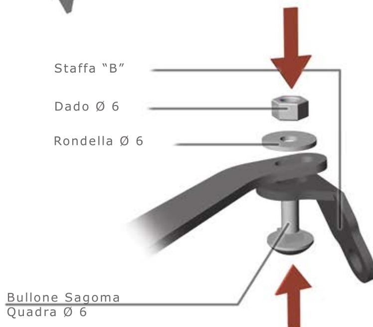
ASSEMBLARE IL CUPOLINO BARRACUDA USANDO LE VITI E GLI SPESSORI IN DOTAZIONE NEL KIT. MONTARE IL TUTTO COME DA ISTRUZIONI. IN FINE SVITARE I BULLONI DELLA FORCELLA (SUPERIORE) E SOSTITUIRLI CON LE BRUGOLE 8X50. SI CONSIGLIA DI STRINGERE IL TUTTO UNA VOLTA MONTATO IL CUPOLINO IN MODO DA EVITARE POSSIBILI ROTTURE STRUTTURALI DOVUTE A FORZATURE.
