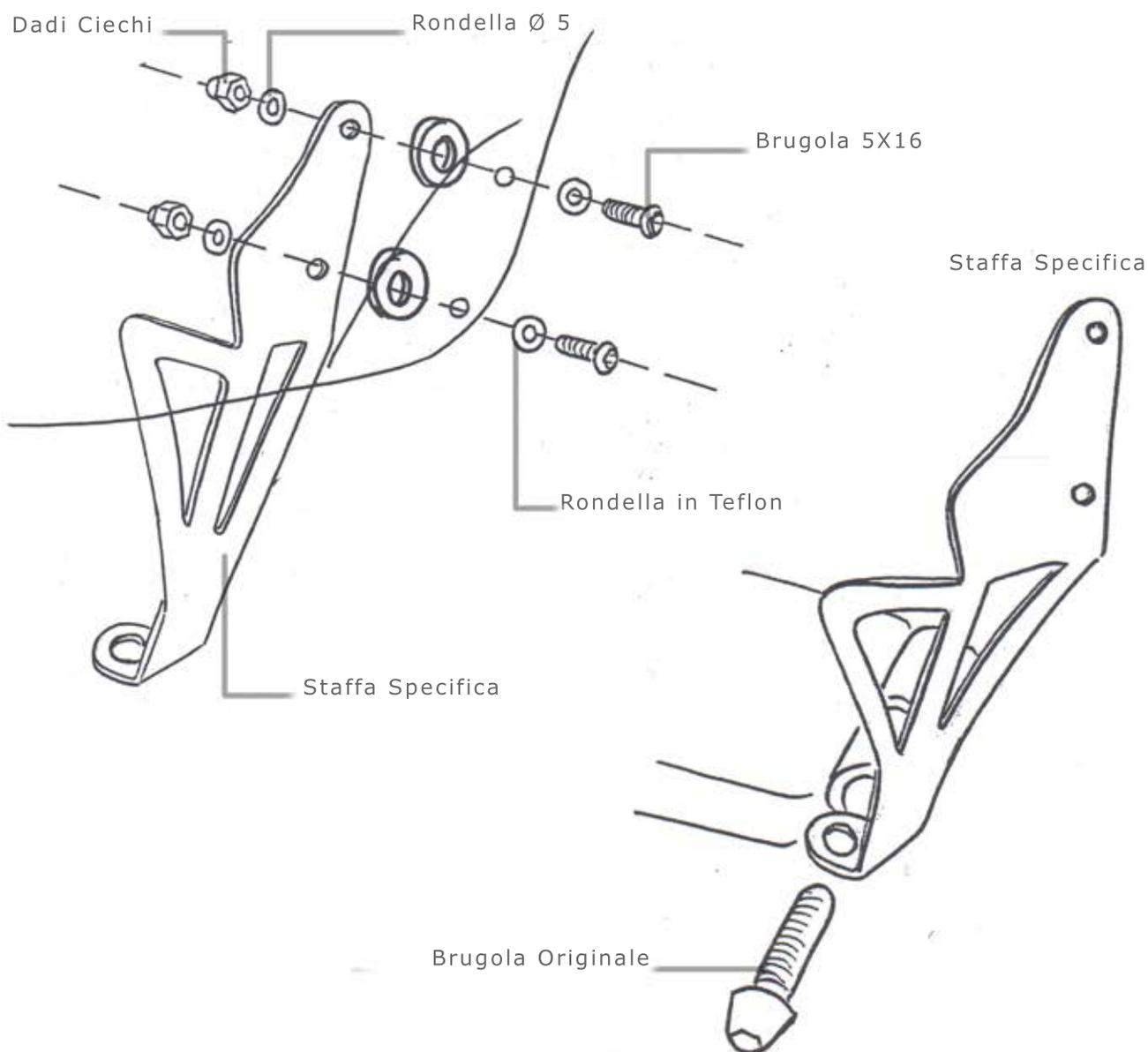
APPLICARE LE DUE STAFFE SULLA PIASTRA DI STERZO UTILIZZANDO LA VITE A BRUGOLA ORIGINALE. FISSARE IL CUPOLINO SULLE DUE STAFFE CON VITI A BRUGOLA 5X16 COME DESCRITTO NELLE IMMAGINI. TROVARE LA CORRETTA POSIZIONE DEL CUPOLINO, SERRARE IL TUTTO ED UTILIZZARE LE QUATTRO RONDELLE IN GOMMA TRA LA STAFFA DI FERRO ED IL CUPOLINO.
