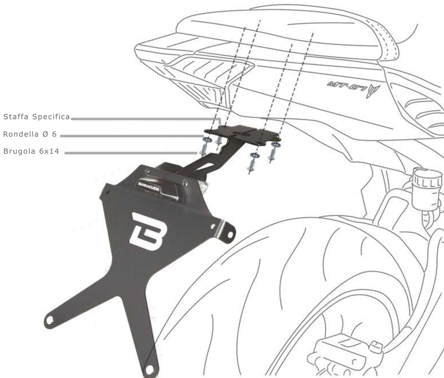
NOTE: SI CONSIGLIA, DI MANTENERE UN INCLINAZIONE NON SUPERIORE A 30° PER NON INCOMBERE IN SANZIONI DEL CODICE DELLA STRADA E PER EVITARE POSSIBILI ROTTURE STRUTTURALI
