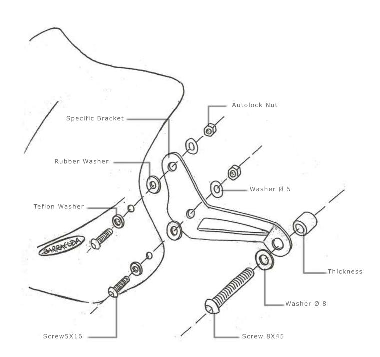
INSTALL THE WINDSHIELD/SCREEN LIKE DESCRIBED IN THE PICTURE:PUT THE TEFLON WASHERS BE-TWEEN THE SCREW AND THE WINDSHIELD/SCREEN. NOTE: DON'T LOCK TOO MUCH THE AUTOLOCK NUTS DIAMETER 5 TO AVOID DAMAGES.
