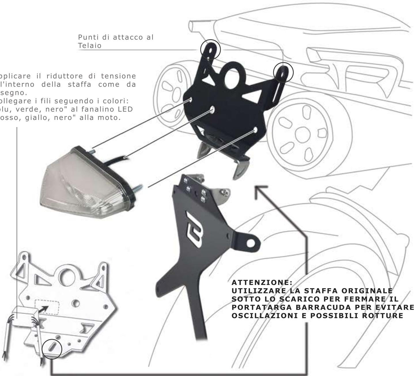
RIMUOVERE IL PORTA TARGA ORIGINALE; APPLICARE IL RIDUTTORE DI TENSIONE ALL'INTERNO DALLA STRUTTURA DEL PORTA TARGA BARRACUDA (VEDI IMMAGINI); MONTARE LA STAFFA SPECIFICA NEI PUNTI DI ATTACCO DEL TELAIO; USARE LA STAFFA ORIGINALE SOTTO LO SCARICO PER FERMARE IL PORTATARGA BARRACUDA PER EVITARE OSCILLAZIONI E POSSIBILI ROTTURE.
