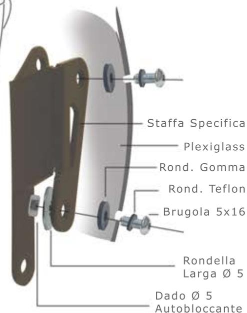
NOTE: NON SERRARE IN MODO ECCESSIVO ONDE EVITARE ROTTURE DEL PLEXIGLASS.
