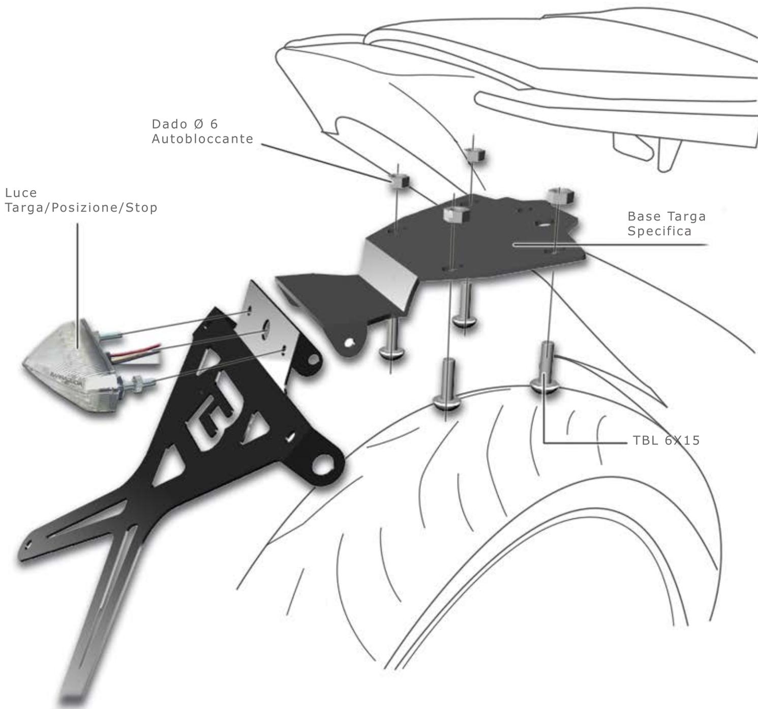
RIMUOVERE IL PORTATARGA ORIGINALE DALLA MOTO. APPLICARE LA STAFFA P. TARGA SPECIFICA BARRACUDA USANDO LA VITERIA TBL 6X15MM IN DOTAZIONE NEL KIT, AVENDO CURA DI FAR PASSARE I CAVI DI ALIMENTAZIONE FRECCHE, STOP E LUCE TARGA NELL'APPOSITA ASOLA E COLLEGARE IL FARO IN DOTAZIONE; MONTARE TUTTO COME DA ILLUSTRAZIONE.
